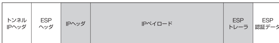
(a) IPsec NATトラバースル適用前のIPsec (ESP) パケット
