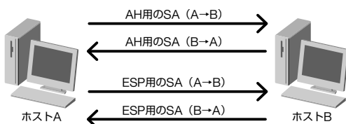
図4 ● IPsecではセキュリティプロトコルごとに行きと帰りで独立したSAを持つ
