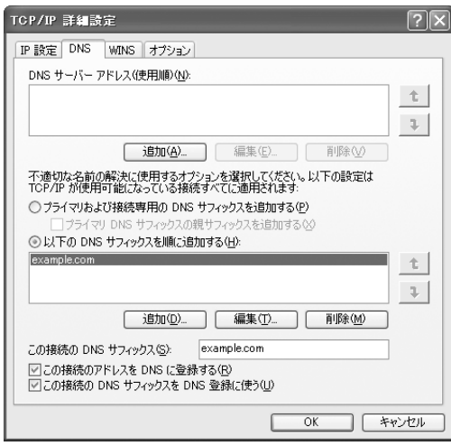
画面1 ● WindowsXPでのDNSダイナミックアップデートの設定は「DNS」タブを選択して行う
